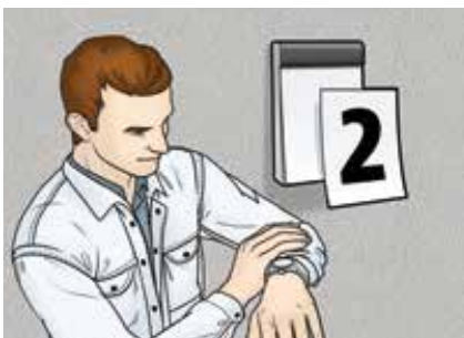
4 Standzeit, je nach Witterung, mindestens 2 Tage (20 °C, 65 % rel. Luftfeuchte).
