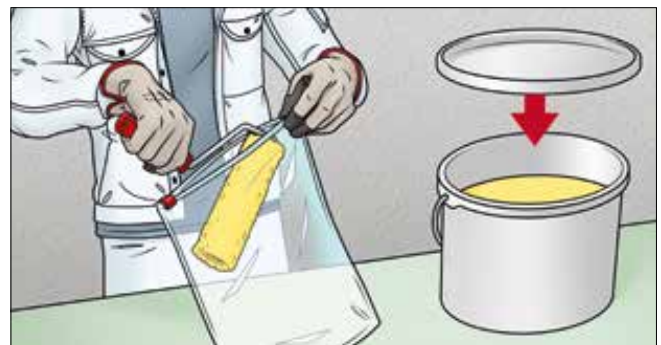
8 Bei längeren Pausen wird das Werkzeug luftdicht verschlossen (z. B. in einem Plastikbeutel). Nach Beendigung der Arbeit wird die Farbe luftdicht verschlossen und die Farbwerkzeuge werden gründlich mit Wasser gereinigt.
