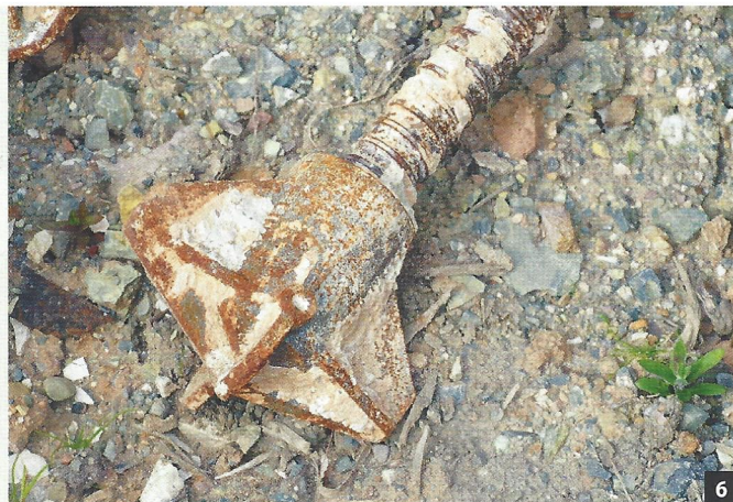
Abb. 6: Der Kopf des Erdsnagels dient als Bohrer. Während der Erdsnagel durch den Boden und die Mauer gebohrt wird, wird eine Zementsuspension durch den Bohrer gepresst und tritt am Kopf über die Düsen wieder aus.
